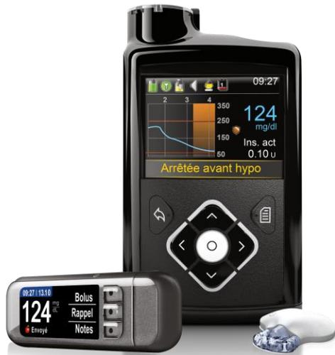
Le système MiniMedtm 640G avec Mesure du Glucose en Continu (MGC) avec fonction exclusive « Arrêt Avant Hypo » : arrêt automatique et prédictif de l'injection d'insuline avant la survenue d'une hypoglycémie et reprise automatique lorsque le risque est écarté.
